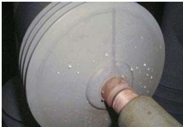
Рис. 2. Каплеобразование на вертикальной поверхности изолятора из НСЕР после 2 лет эксплуатации (Kitty Hawk, NC, USA) – свидетельство сохранности гидрофобных свойств в условиях морского климата
